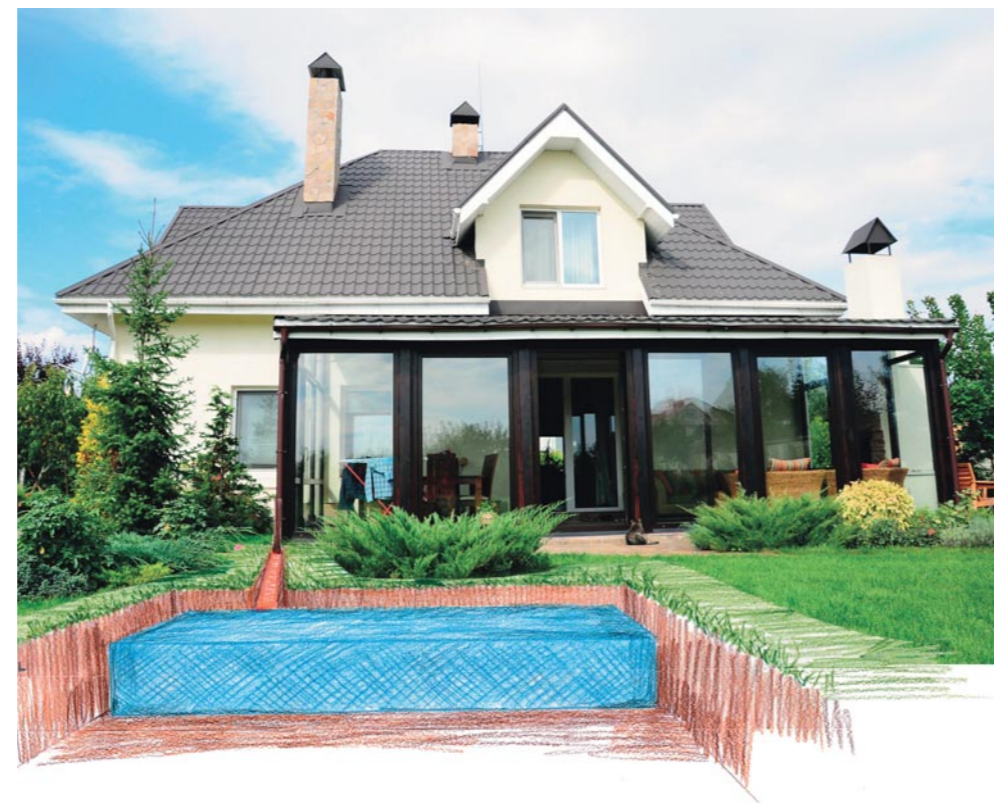
Ondergrondse infiltratiekratten gevuld met steentjes zorgen van een betere instroming van het regenwater in de bodem.
